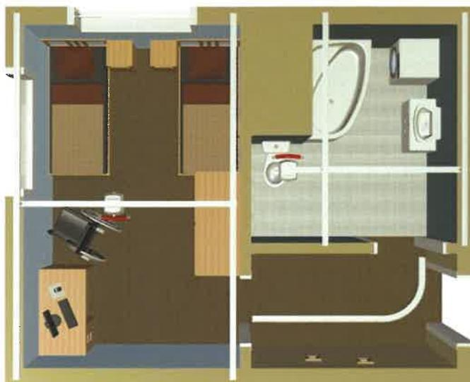
Kombinací oblouků a přímých úseků lze sestavit dráhu téměř libovolného tvaru tam, kde nepotřebujete, nebo nemůžete manipulovat v celé ploše místnosti. Vzhledem k tomu, že přímá dráha neumožňuje obsluhu prostoru, je vhodná zejména jako propojovací prvek mezi jednotlivými místnostmi.
